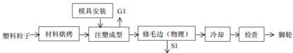
图 2-2 注塑脚轮工艺流程图
