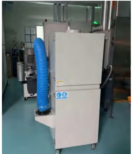
移动式废气处理装置
