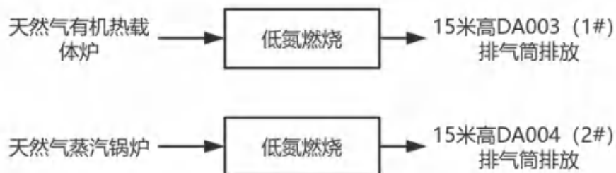
图 4-1 废气处理流程示意图
