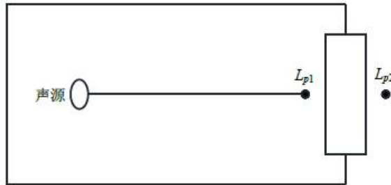
图 4-5 室内声源等效为室外声源图例
