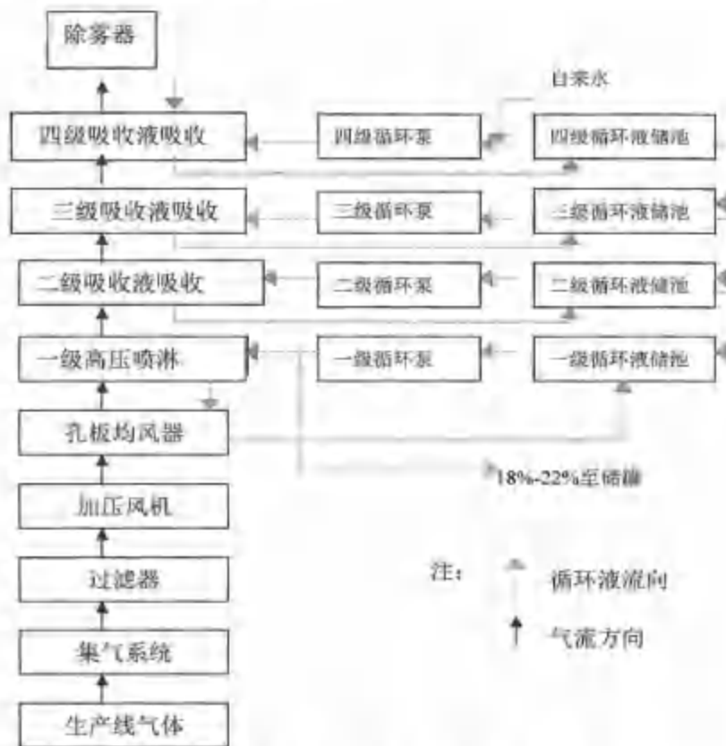
图 4-2 DMF 喷淋吸收系统四级吸收循环工艺流程图
