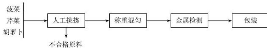
图 2-13 蔬菜干制品（冷冻干燥蔬菜）生产工艺流程图
