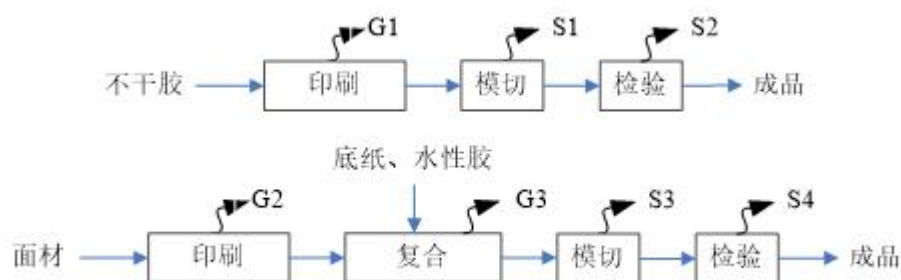
图 2-6 防伪标签生产工艺流程图
