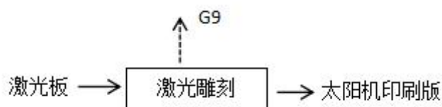
图 2-3 印刷工艺流程图
