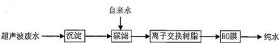
图 4-1 纯水工艺流程
