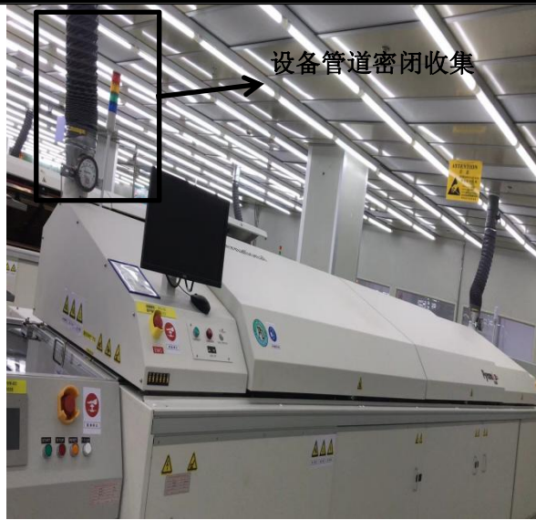
图 3-5 回流焊废气收集情况（以新带老）
