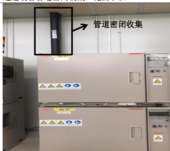
图 3-3 塑封烘烤废气收集情况
