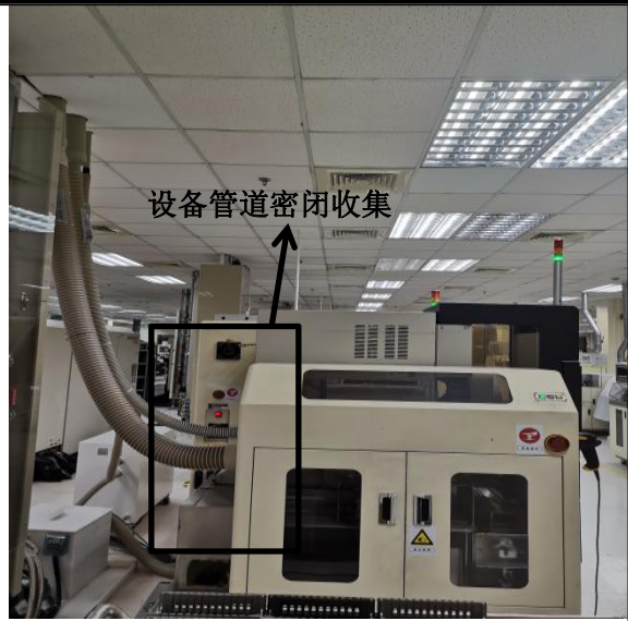
图 3-6 清洗擦拭废气收集情况（以新带老）
