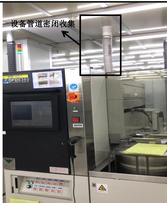
图 3-1 晶圆粘贴废气收集情况
