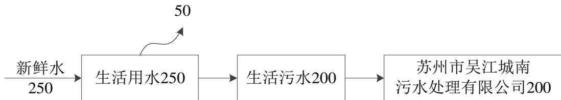
图 2-7 现有项目水平衡 (t/a)
