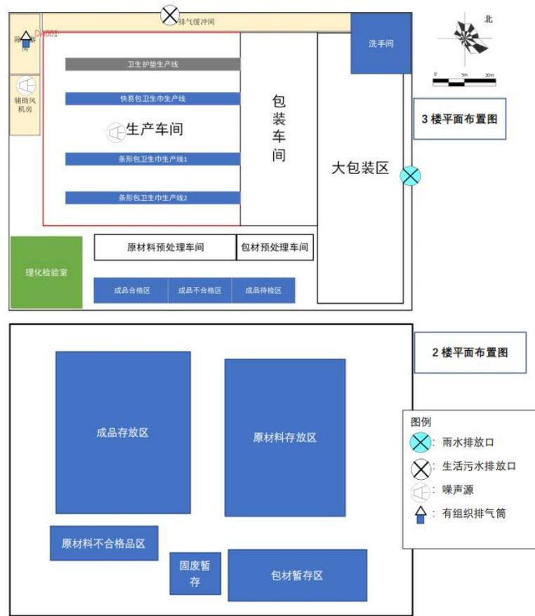
图4 厂区平面布置示意图
