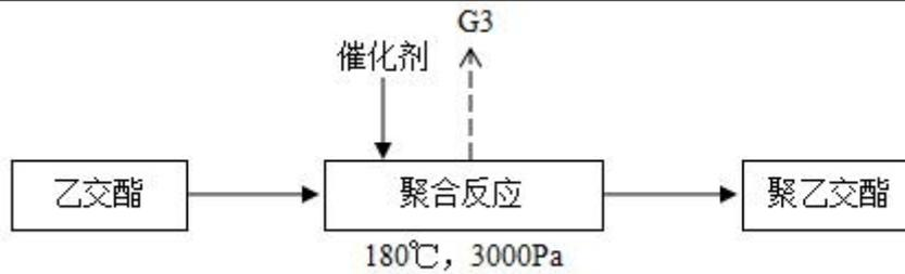
图 2-2 聚乳酸、聚乙交酯合成工艺流程图
