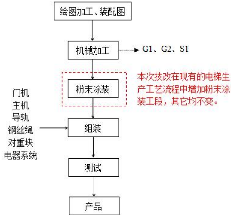
图 2-4 电梯生产工艺流程图
