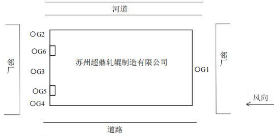
无组织废气采样点：OG1：厂界上风向测点；OG2、OG3、OG4：厂界下风向测点；OG5、OG6：厂区内测点。
