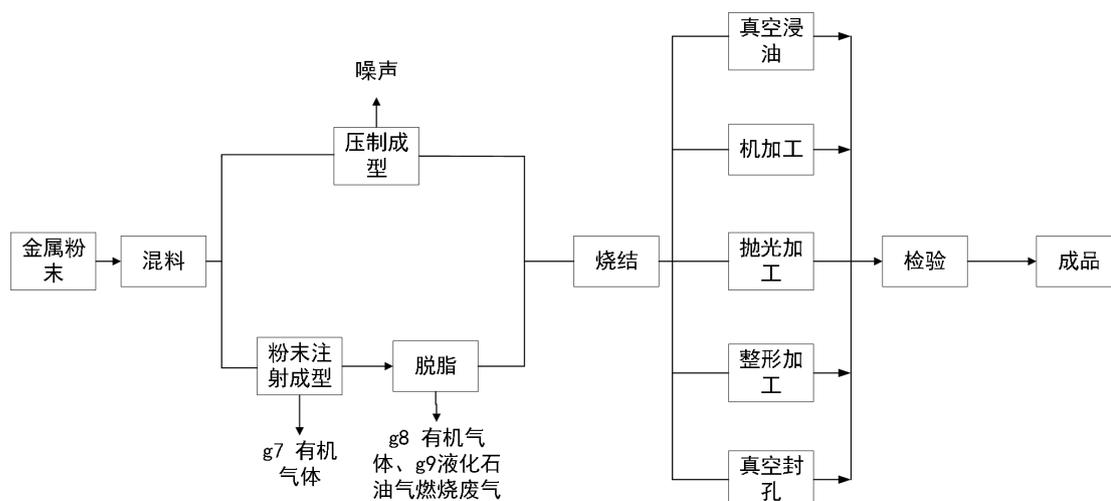
图 2-9 金属零部件生产工艺及产污情况示意图
