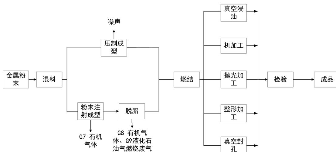
图 3-3 金属零部件生产工艺及产污情况示意图
