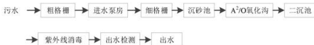
图 7-1 吴江市震泽镇生活污水处理有限公司处理工艺流程图
